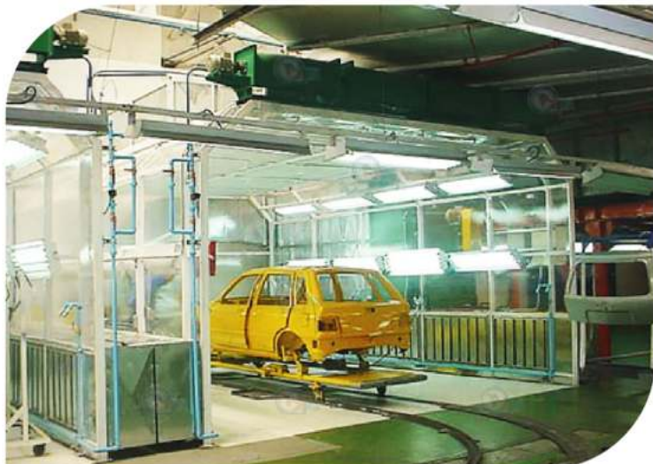
Cabinas de pintura
